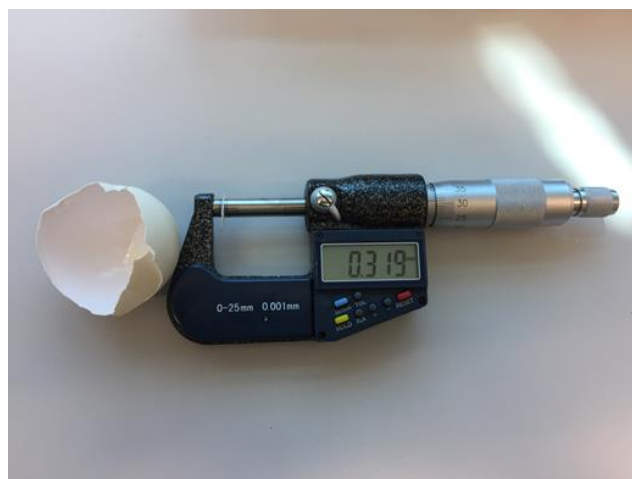
Slika 12. Mjerenje debljine ljuske jajeta
