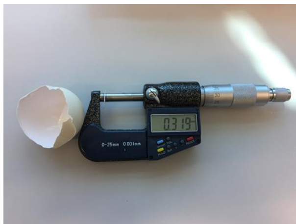
Slika 8. Mjerenje debljine ljuska jajeta
