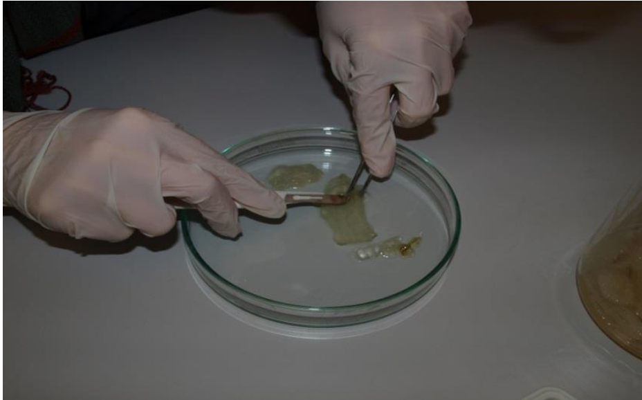
Slika 1. Čišćenje vlakana iz Aloe vera pulpe (foto: Barišić, M.)
