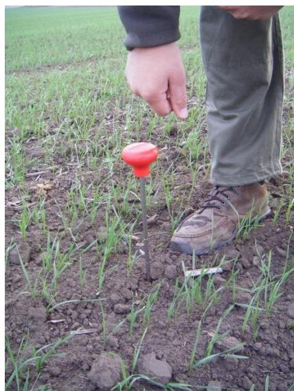
Slika 12. Štapna sonda tvorničke izrade
