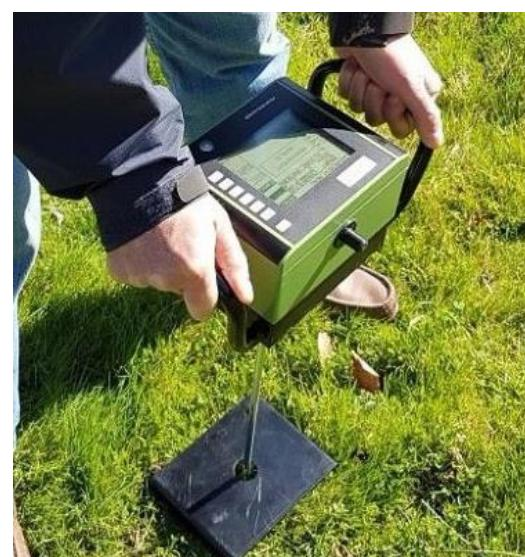
Slika 15. Mehanički penetrometar
