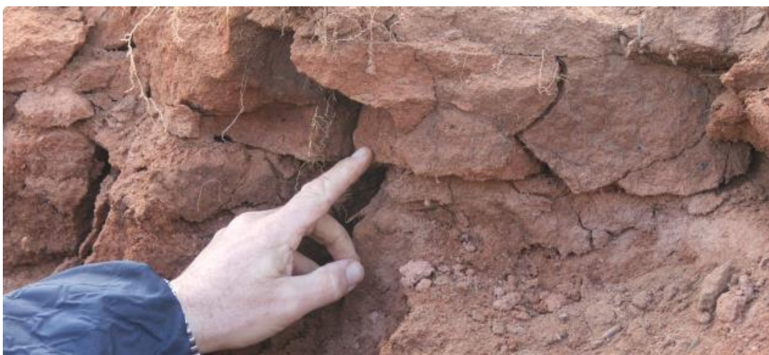
Slika 7. Podpovršinska zbijenost horizonta tla
