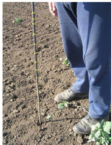
Slika 13. Štapna sonda izrađena u kućnoj radinosti (Jug i sur., 2015.)
