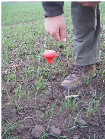
Slika 12. Štapna sonda tvorničke izrade (Jug i sur., 2015.)
