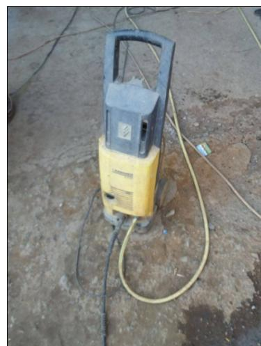
Slika 4. Visokotlačni čistač „Karcher k5“
