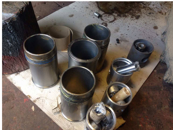
Slika 15. Novi klipovi i košuljice cilindara (Izvor: Vlastita fotografija)
