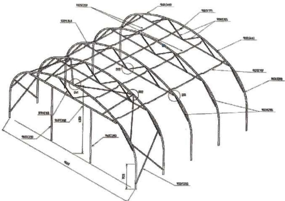
Slika 15: Shematski prikaz konstrukcije plastenika
