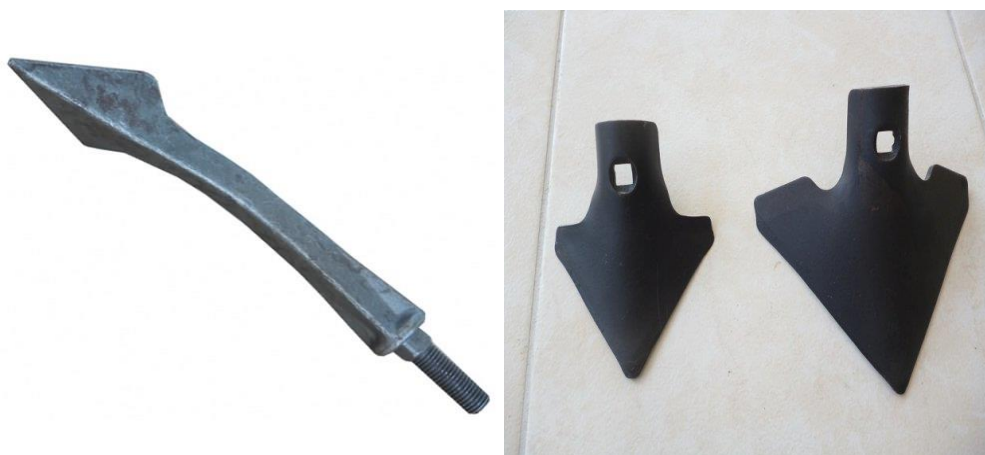
Slika 19. Klin drljače (lijevo) i motičica kultivatora (desno)
