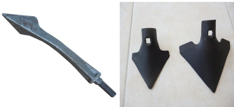
Slika 19. Klin drljače (lijevo) i motičica kultivatora (desno)
