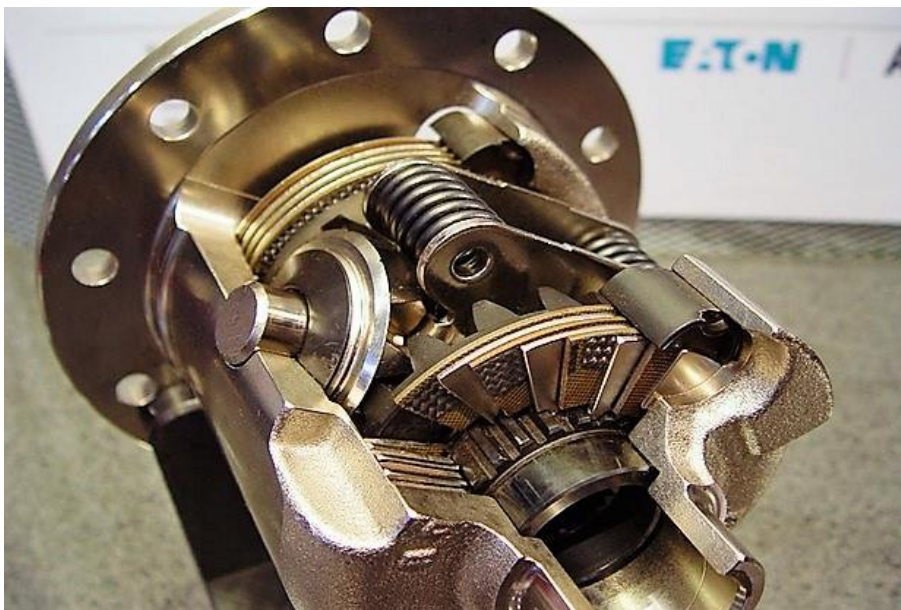
Slika 11. Presjek konstrukcije diferencijala s ograničenim proklizavanjem (Izvor: Ćosić, 2013.)
