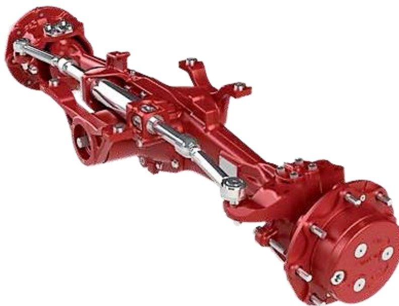
Slika 13. Spoj prednjih poluvratila diferencijalom s ograničenim proklizavanjem (Izvor: http://www.carrarodrivetech.com/media/u/sheet_en/2015/AG_Technical_Data_2015.pdf )
