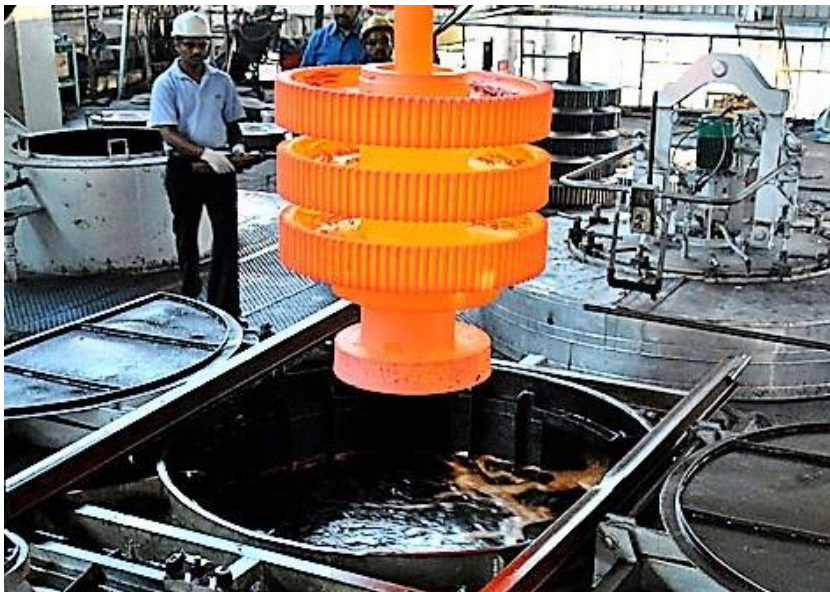
Slika 34. Kaljenje zupčanika u uljnoj kupci
