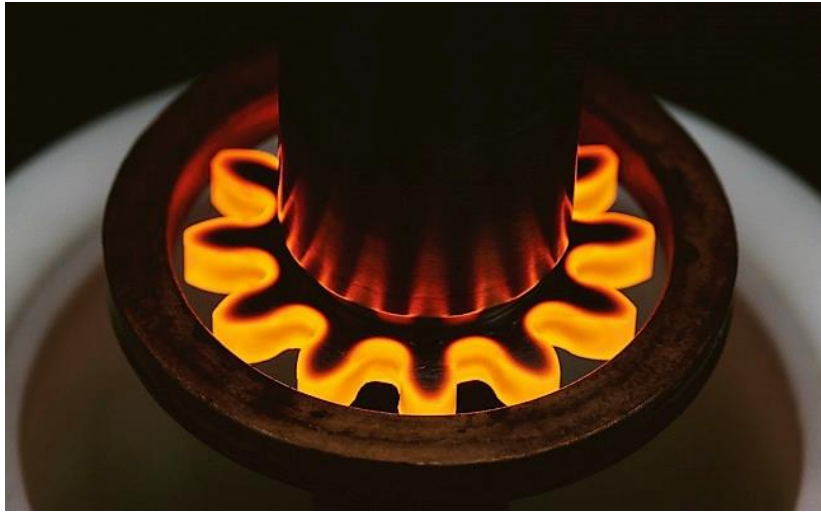
Slika 35. Indukcijsko zagrijavanje zupčanika
