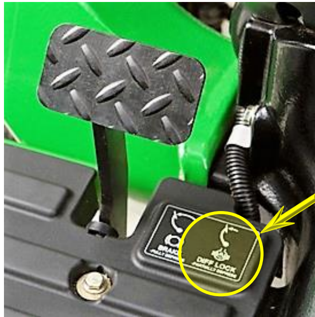
Slika 15. Papučica za zaključavanje diferencijala traktora „John Deere“
