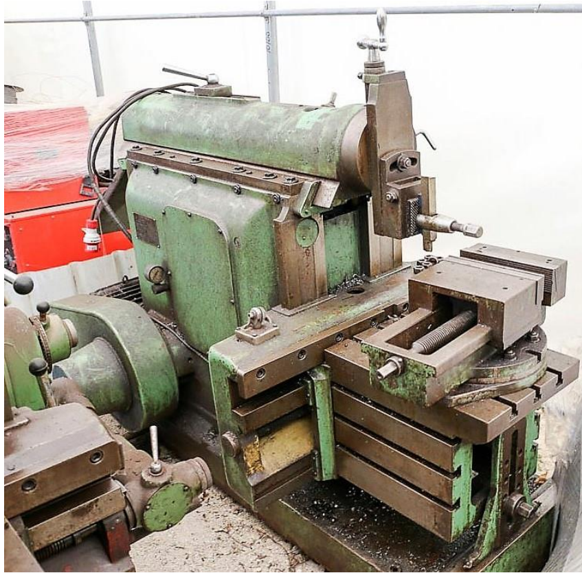
Slika 28. Kratkohodna blanjalica (Izvor: http://web-trgovina.metal-kovis.hr/slike/velike/blanjalica-hidraulicna-hod-700-mm-C-145_1.jpg )
