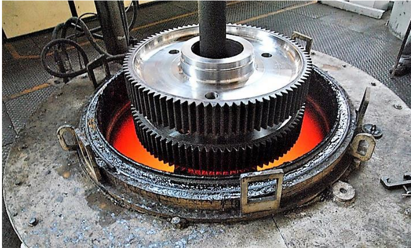
Slika 33. Zagrijavanje zupčanika u plinskim pećima
