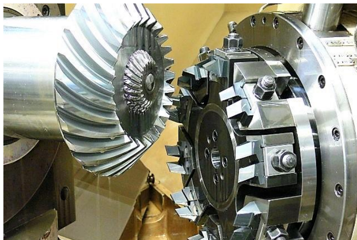
Slika 25. Glodanje zupčanika Klingelberg metodom (Izvor: https://www.tandler.de/unternehmen/fertigung-maschinenpark/kegelradverzahnen/ )
