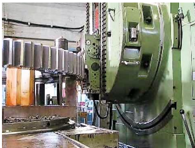
Slika 30. Izrada cilindričnih zupčanika Maag metodom
