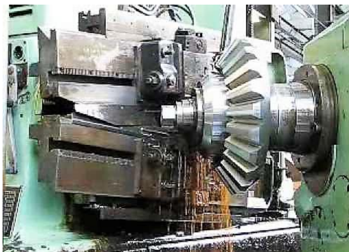
Slika 30. Izrada konusnih zupčanika Oerlikon metodom (Izvor: https://i.ytimg.com/vi/Adi0GgUc2Z4/hqdefault.jpg )
