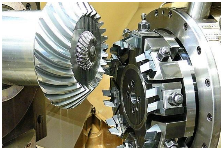
Slika 25. Glodanje zupčanika Klingelberg metodom (Izvor: https://www.tandler.de/unternehmen/fertigung-maschinenpark/kegelradverzahnen/ )
