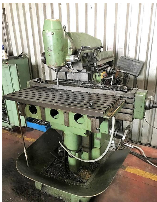
Slika 19. Univerzalna glodalica (Izvor: autor)
