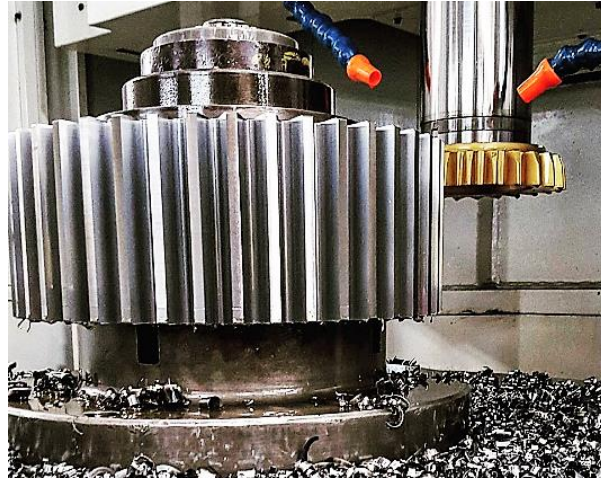
Slika 29. Izrada cilindričnih zupčanika Fellows metodom
