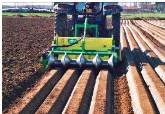
Slika 5. Stroj za formiranje gredica ( http://www.polje.hr/default.aspx?id=29 )
