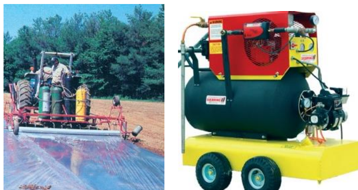
Slike 10 i 11. Traktorski nošeni uređaj za paru dezinfekciju zemljišta na otvorenom polju ( http://www.poljoberza.net/ )
