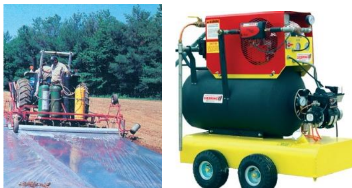
Slike 10 i 11. Traktorski nošeni uređaj za paru dezinfekciju zemljišta na otvorenom polju ( http://www.poljoberza.net/ )
