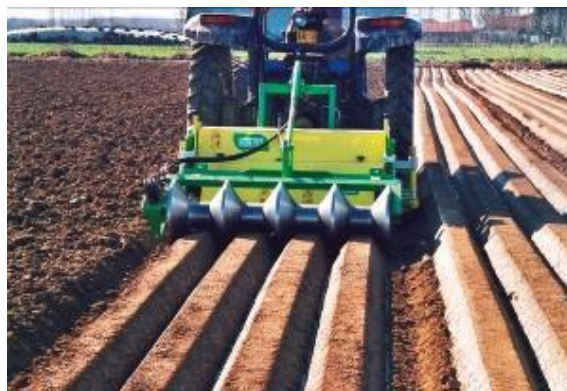
Slika 5. Stroj za formiranje gredica ( http://www.polje.hr/default.aspx?id=29 )
