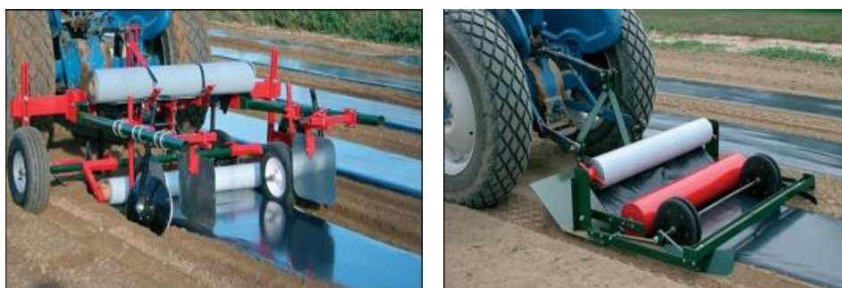
Slike 8 i 9. Postupak nastiranja (malčiranja) tla ( http://www.poljoberza.net )
