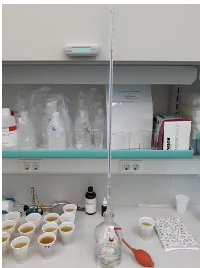
Slika 10. Uzorci mošta i bireta za titraciju (Autor, 2017.)
