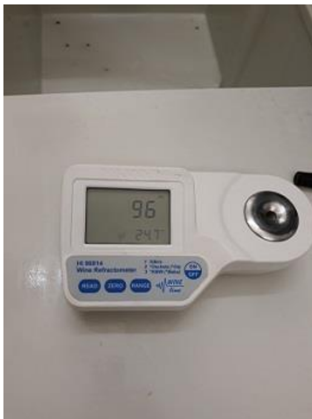
Slika 9. Digitalni refraktometar marke Hanna (Autor, 2017)
