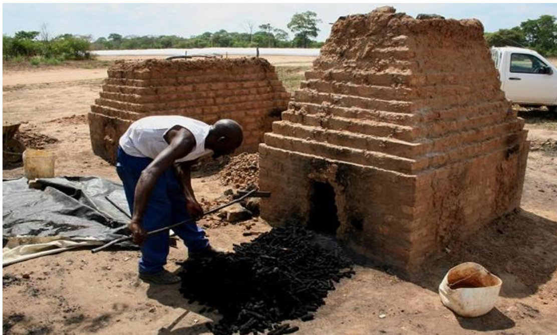
Slika 6. Peć od cigala sagrađena za proizvodnju biougljena
