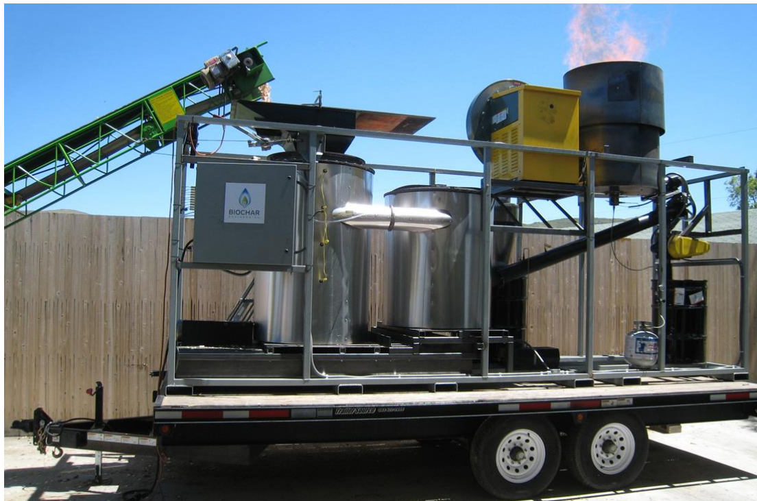
Slika 7. Mobilna jedinica za proizvodnju biougljena
