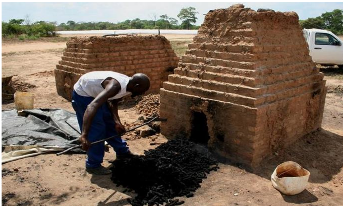
Slika 6. Peć od cigala sagrađena za proizvodnju biougljena
