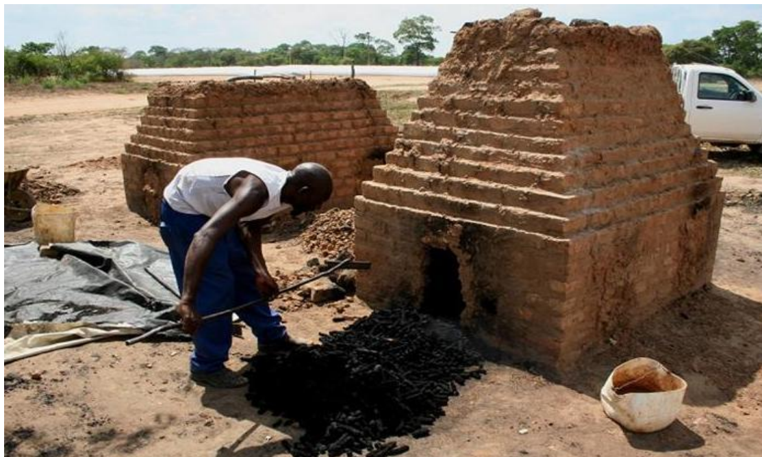
Slika 6. Peć od cigala sagrađena za proizvodnju biougljena
