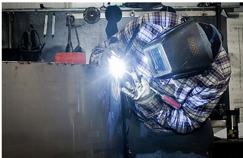
Slika 28. Popravak nehrđajuće posude u proizvodnji vina (Izvor: http://www.thedalleschronicle.com/news/2015/mar/28/wine-and-steel/ )
