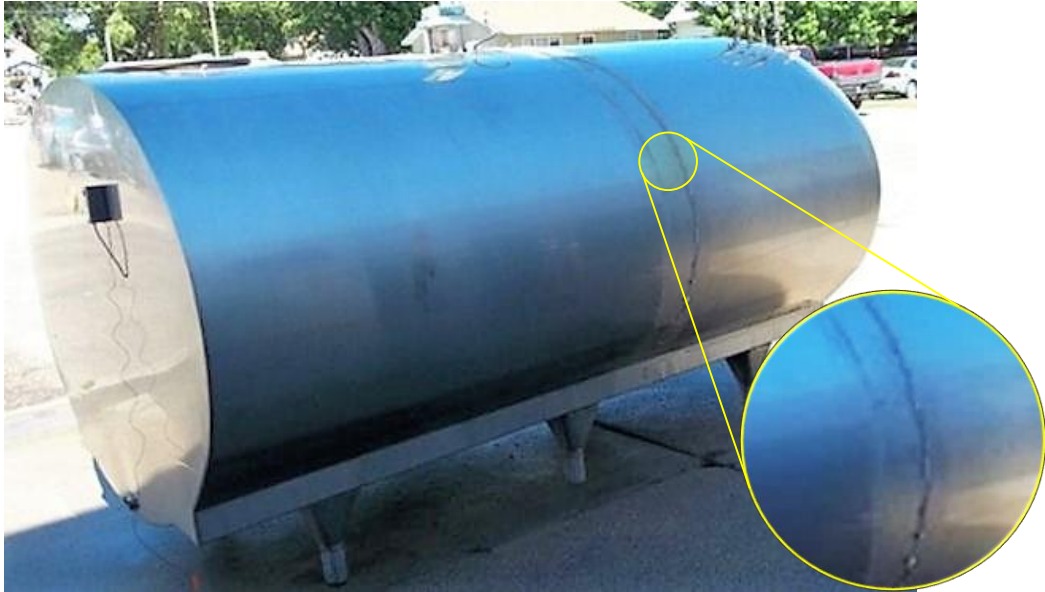
Slika 23. Reparaturno zavarivanje spremnika za mlijeko (Izvor: http://www.schiercompany.com/FarmTanks.html )
