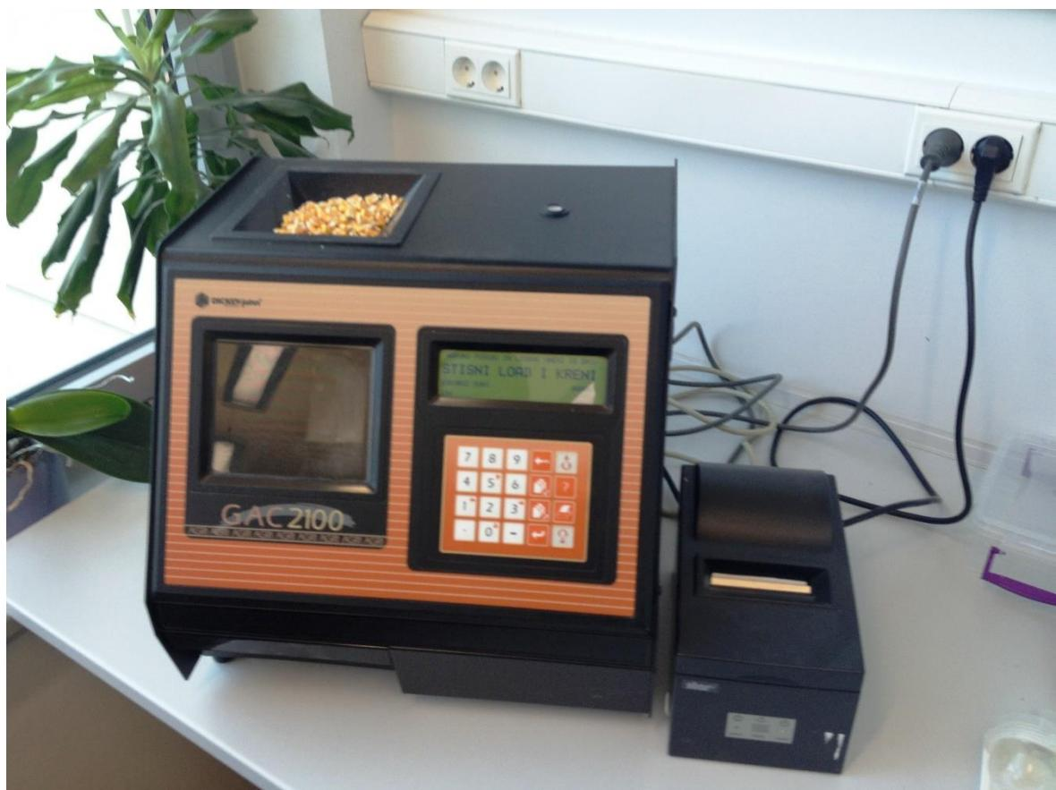
Slika 7. Uređaj za mjerenje vlage, temperature i hektolitarske mase zrna s pisačem
