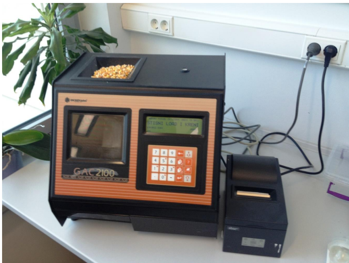
Slika 7. Uređaj za mjerenje vlage, temperature i hektolitarske mase zrna s pisačem DICKEY-john® GAC 2100 (Foto: Vlatka Rozman)
