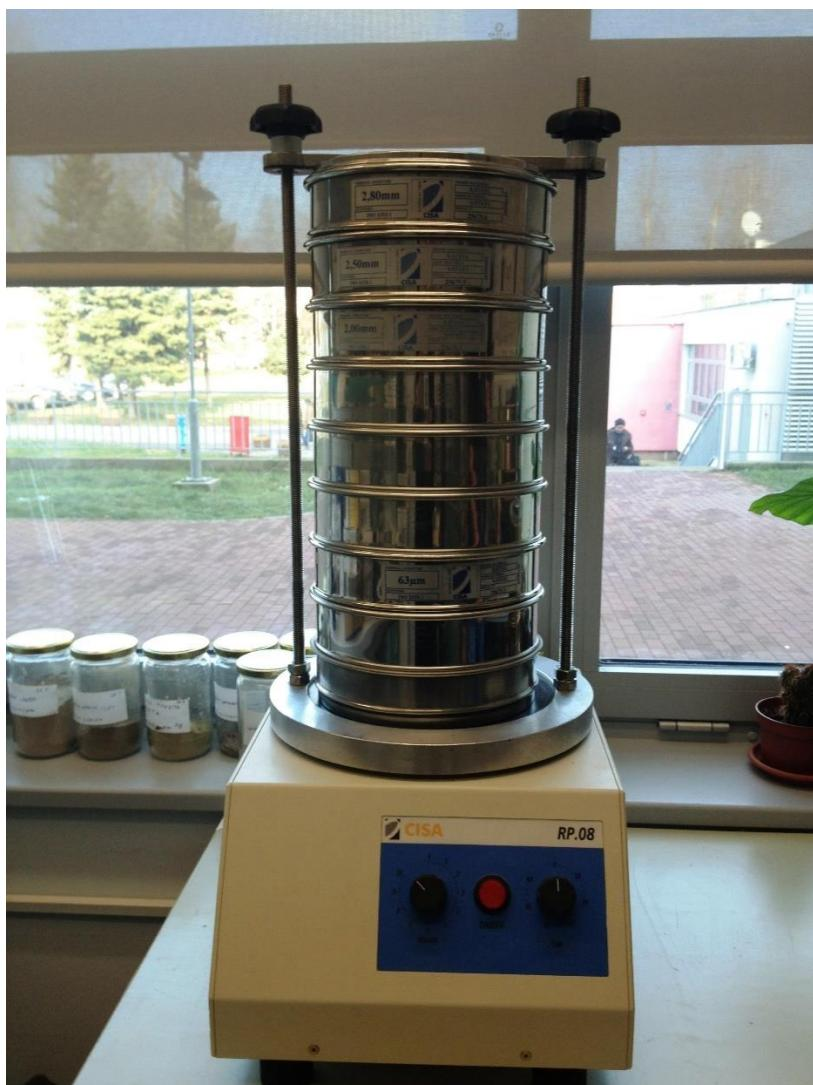
Slika 8. Elektromagnetska tresilica za prosijavanje CISA RP08 ø200/203
