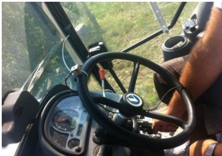
Slika 7. Senzor uređaja za mjerenje razine vibracija (vlastita fotografija)
