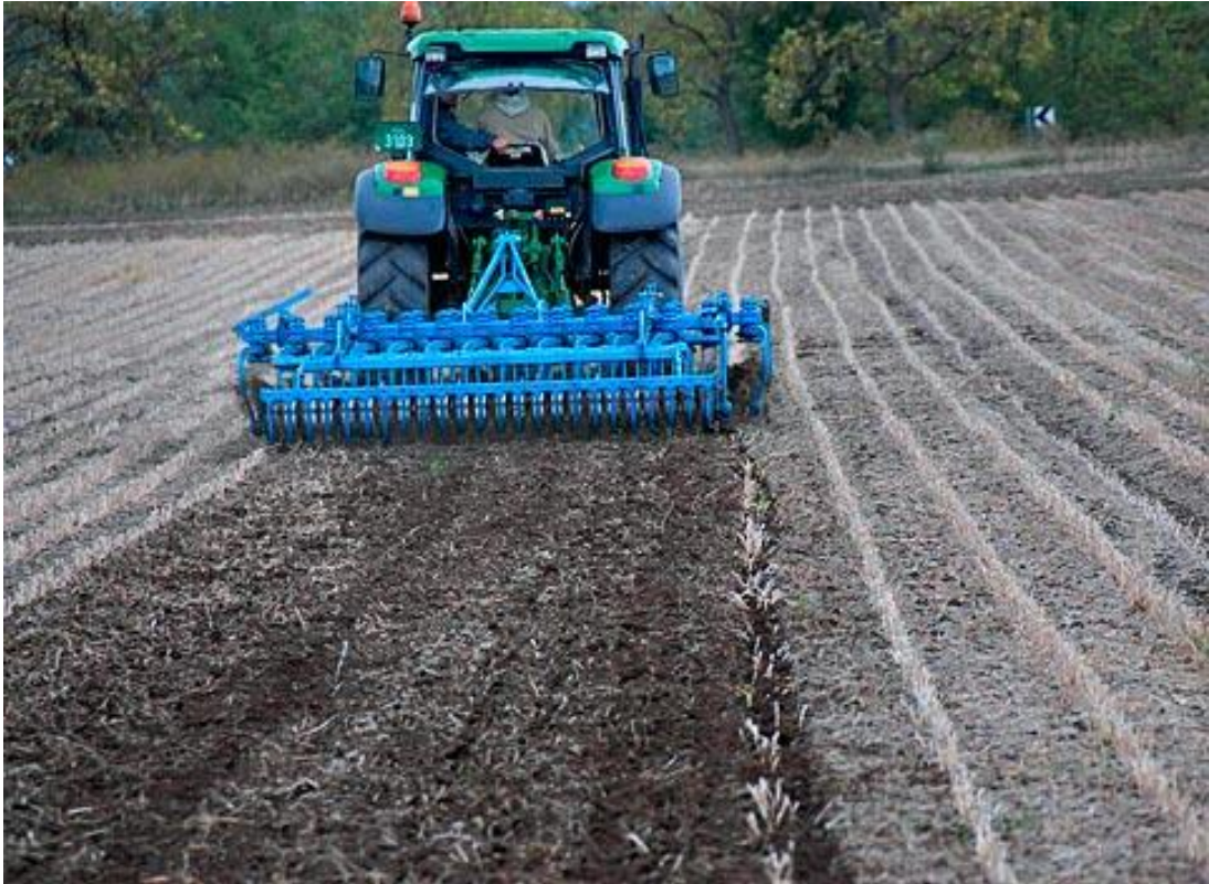
Slika 1. Konzervacijska obrada tla
