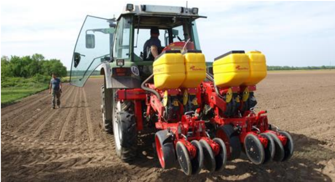
Slika 5: MaterMacc sijačica Twin Row (Izvor: http://www.savjetodavna.hr/adminmax/images/news/2016-04/traktor2542016.jpg )
