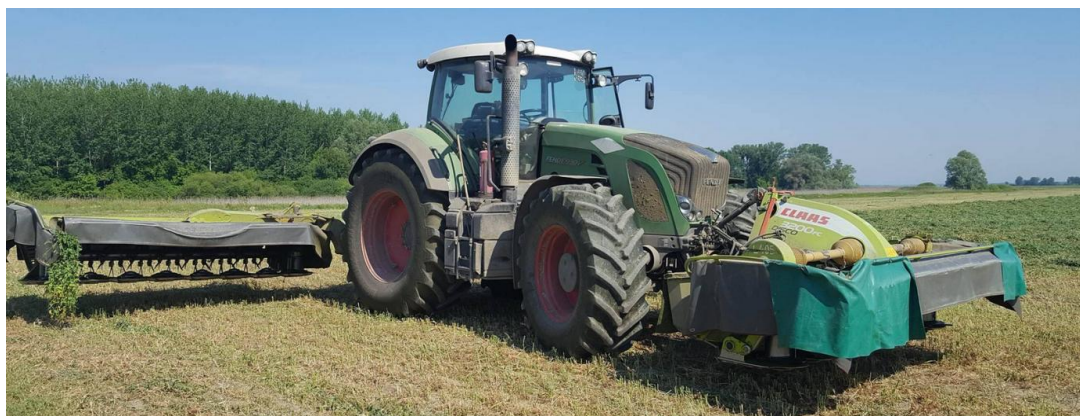
Slika 7. Traktor u košnji s kosilicom "Claas 3200 FC DISCO" (Izvor: vlastita fotografija)
