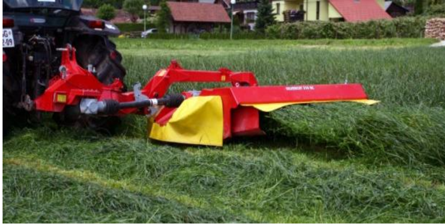
Slika 9. Kosilica-gnječilica „SIP SIL VERCUT DISC 270 S RC“ (Izvor: link 5.)
