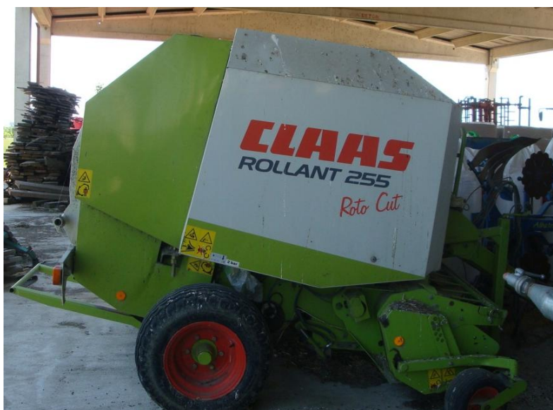
Slika 16. Preša tipa Claas Rollant 255 Roto Cut za valjkaste bale (Izvor: vlastita fotografija)
