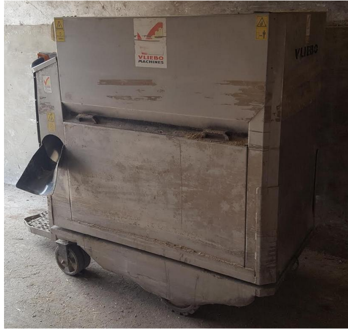
Slika 34. Vliebo mikser za stočnu hranu (Izvor: vlastita fotografija)
