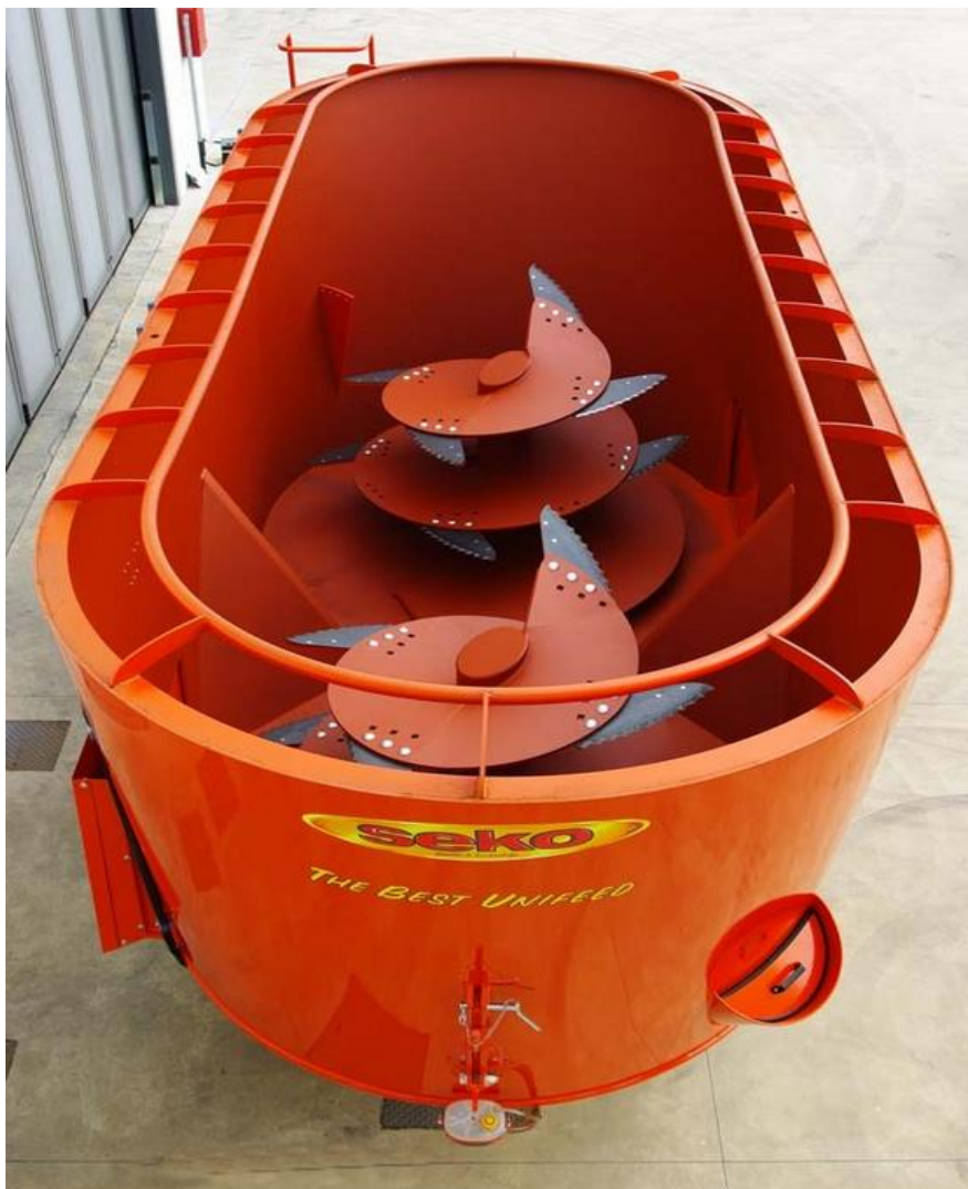
Slika 32. Prikaz unutrašnjosti mikser prikolice „SEKO Tiger VLM 240“ (Izvor: link 13.)
