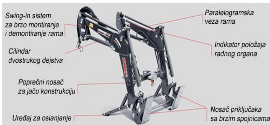
Slika 30. Konzola prednjeg traktorskog utovarivača (Izvor: link 12.)
