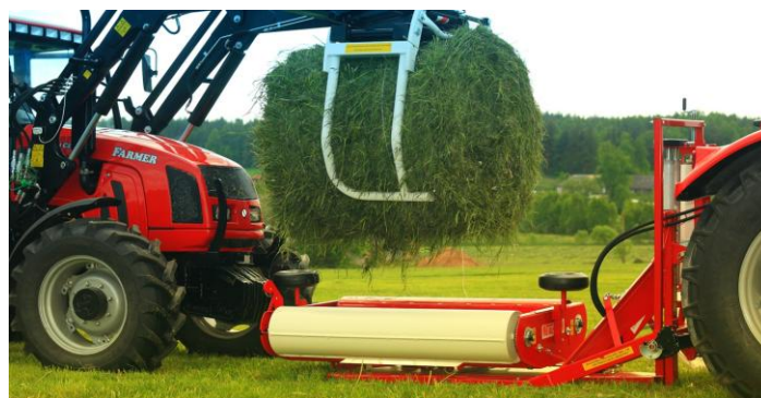
Slika 18. Stavljanje bale sijena na omotač bala (link 9.)
