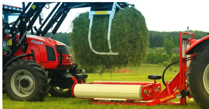
Slika 18. Stavljanje bale sijena na omotač bala (link 9.)
