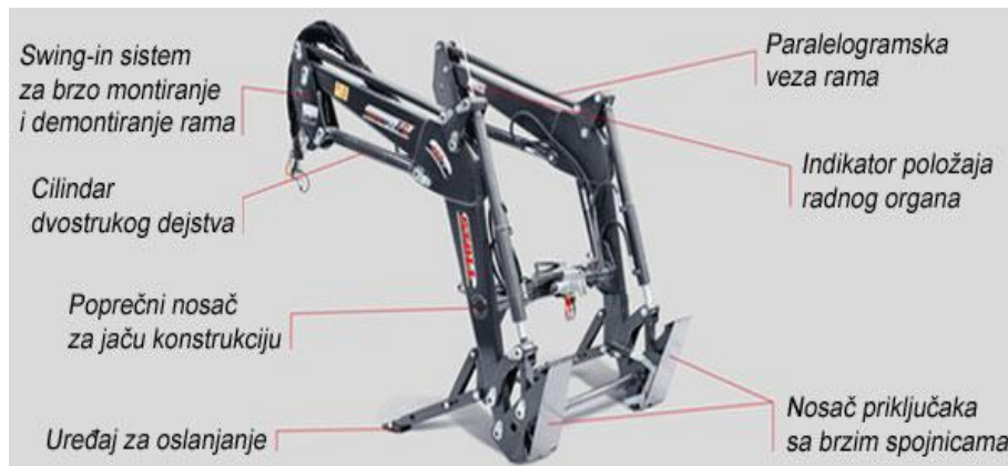
Slika 30. Konzola prednjeg traktorskog utovarivača (Izvor: link 12.)
