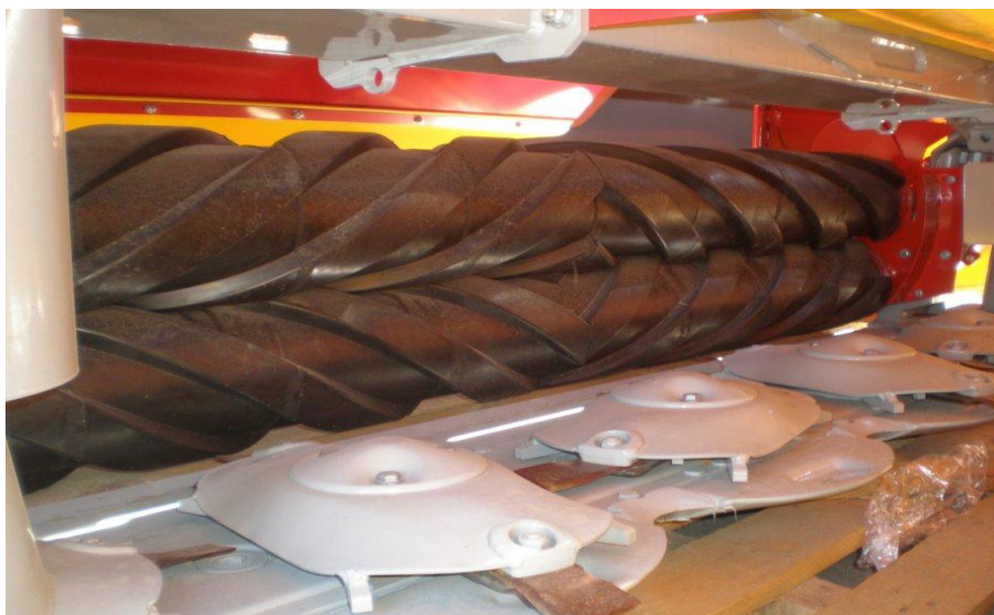
Slika 10. Unutrašnjost kosilice - gnječilice s valjcima „SIP“ (Izvor: link 6.)
