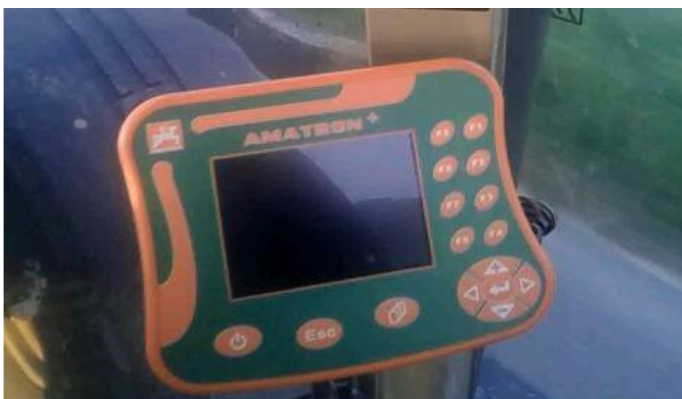
Slika 2. . „AMATRON+“ - Kontrolni monitor u kabini traktora sijačice „Amazona“ (Izvor-vlastita fotografija)
