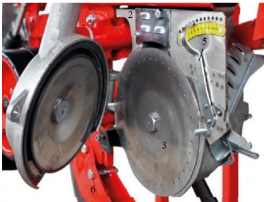
Slika 1. Pneumatski sjetveni uređaj s podtlakom( 2-kućište sjetvenog uređaja, 3- sjetvena pločica, 5- čistač viška sjemena, 6- ulagač sjemena) ( Izvor: http://www.cetinkayalartarim.com/en/products/12/pneumatic-seeder )
