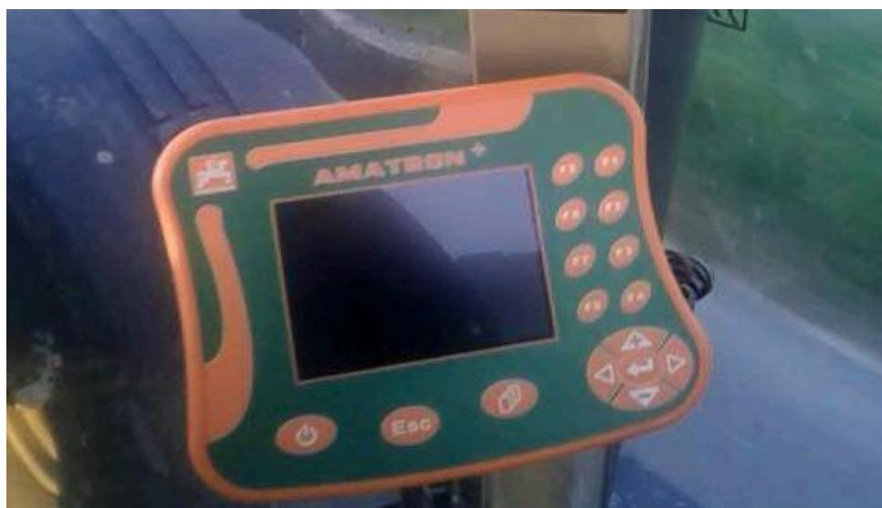
Slika 2 . „AMATRON+“ - Kontrolni monitor u kabini traktora sijačice „Amazone“ (Izvor-vlastita fotografija)
