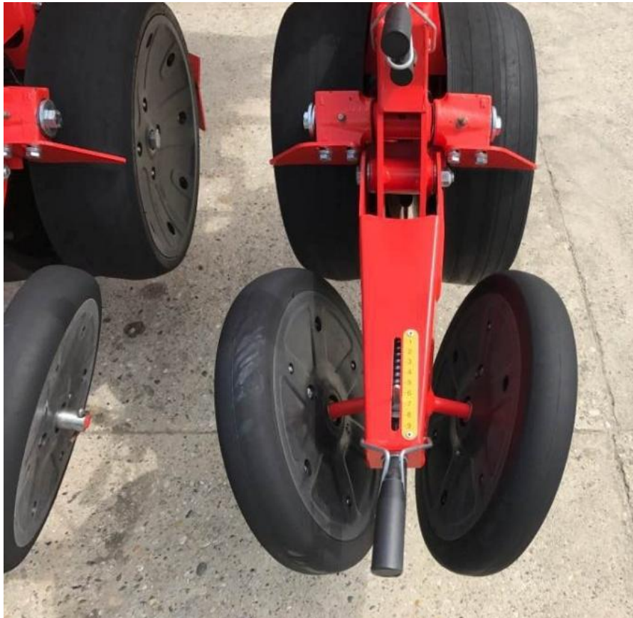
Slika 7 . Ručica za podešavanje dubine sjetve (Izvor- vlastita fotografija)
