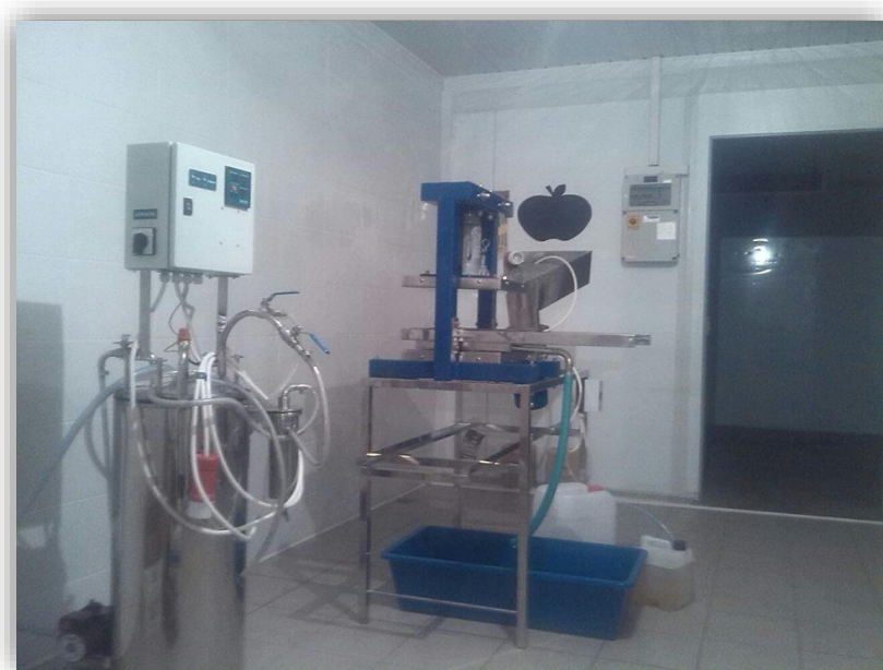
Slika 13. Stroj za proizvodnju soka od jabuka (izvor: Klarić)
