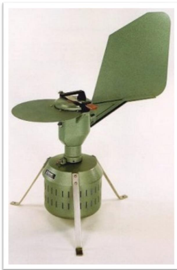
Slika 2. Klopka za pelud i spore
