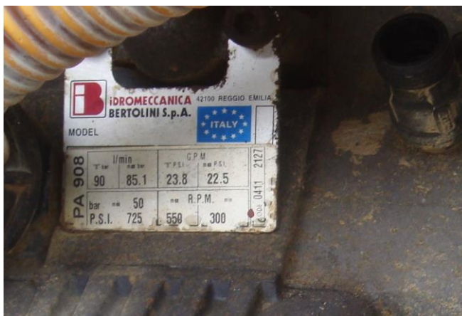
Slika 3. Pločica proizvođača na klipno-membranskoj crpki
