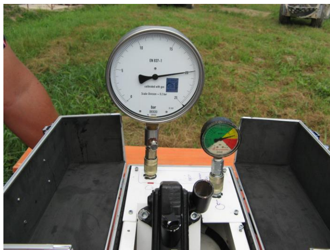
Slika 16. Provjera ispravnosti manometra kod raspršivača PIAVE I
