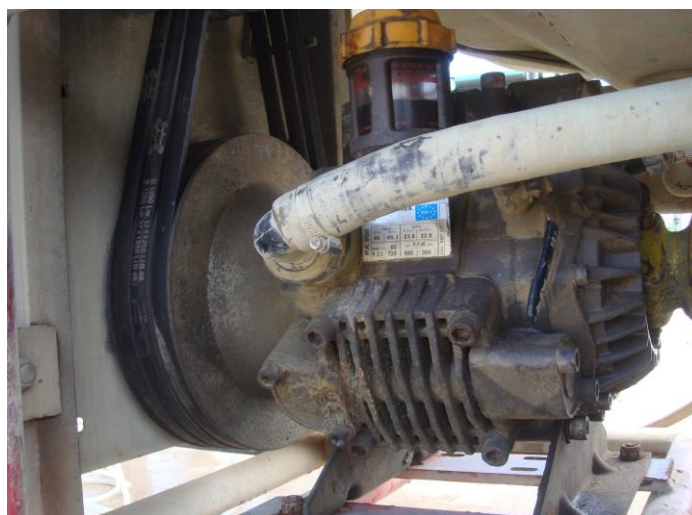
Slika 2. Klipno-membranska crpka talijanske tvrtke BERTOLINI s.p.a – Model PA 908
