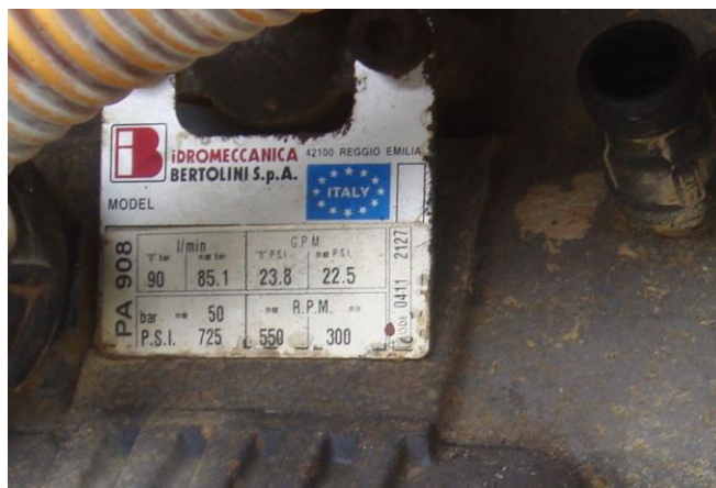
Slika 3. Pločica proizvođača na klipno-membranskoj crpki
