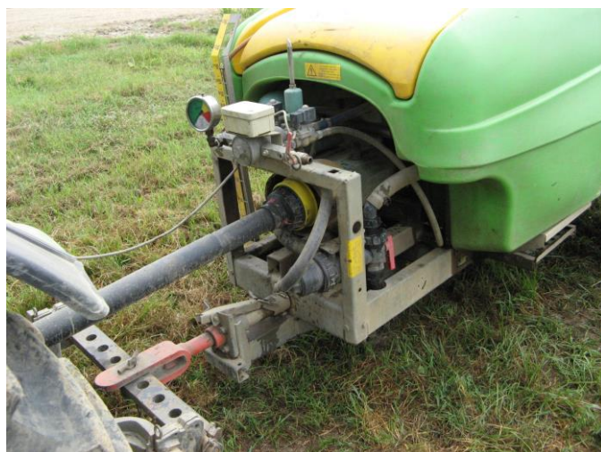
Slika 1. Pravilno postavljena zaštita priključnog vratila
