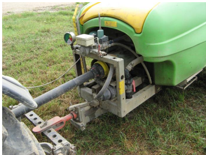
Slika 1. Pravilno postavljena zaštita priključnog vratila
