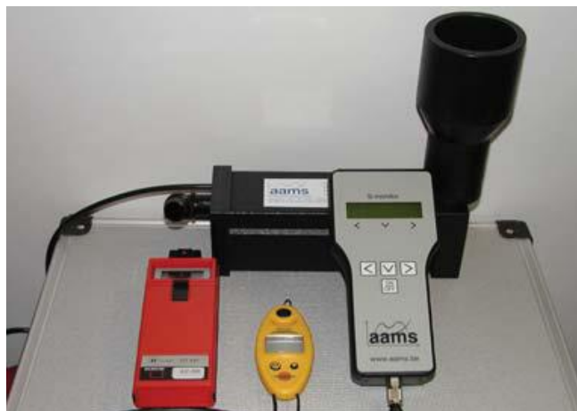
Slika 9. Uređaj AAMS za mjerenje protoka mlaznica
