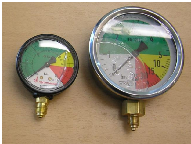
Slika 5. Uređaji za kontrolu tlaka promjera 63 i 100 mm
