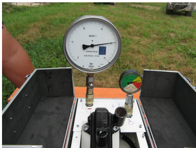
Slika 16. Provjera ispravnosti manometra kod raspršivača PIAVE I
