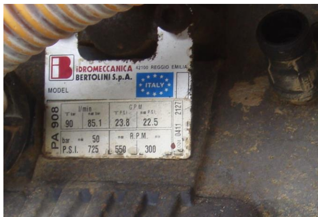
Slika 3. Pločica proizvođača na klipno-membranskoj crpki
