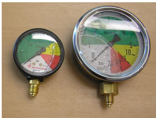
Slika 5. Uređaji za kontrolu tlaka promjera 63 i 100 mm
