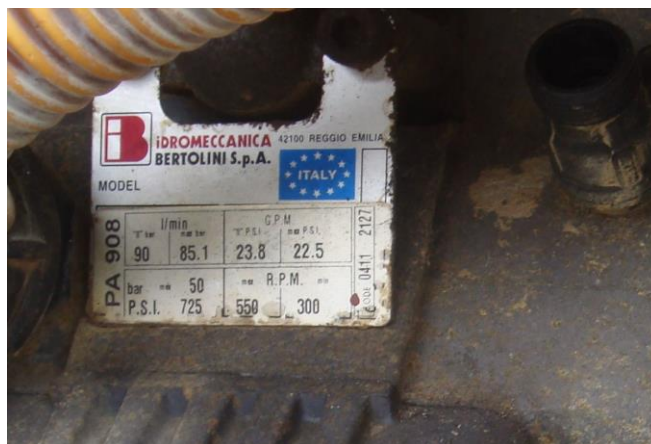
Slika 3. Pločica proizvođača na klipno-membranskoj crpki
