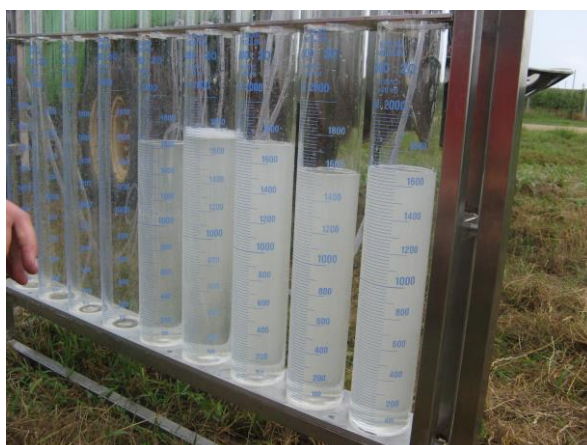
Slika 17. Protok na lijevoj strani gore navedenog raspršivača tvrtke Munckof
