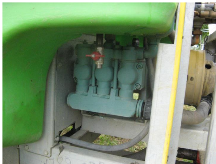
Slika 13. Klipna crpka raspršivača Munckof
