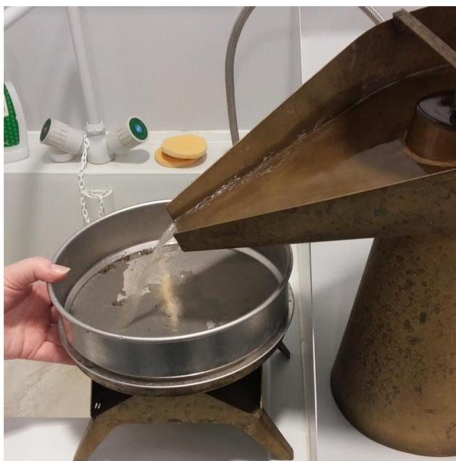
Slika 17. Sito za sakupljanje ekstrahiranog sadržaja iz uzorka, promjera  $250\mu\text{m}$
