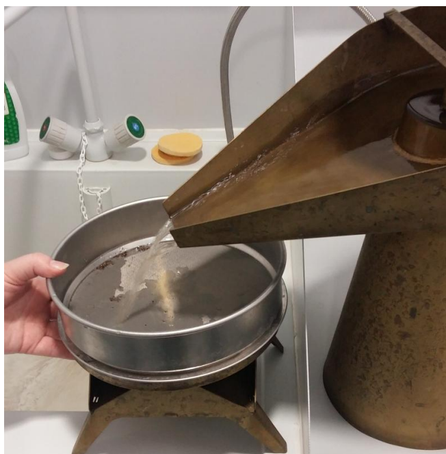
Slika 17. Sito za sakupljanje ekstrahiranog sadržaja iz uzorka, promjera 250\mu\text{m} (Izvor: Anja Kolarić)
