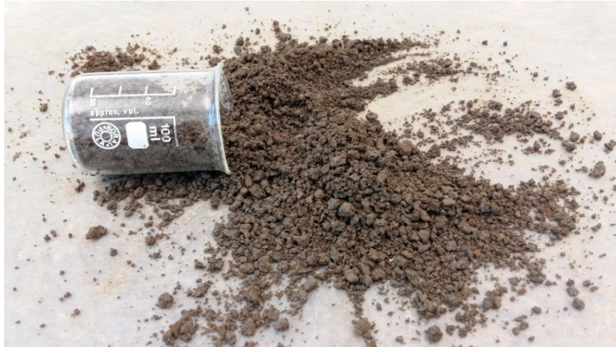
Slika 14. Izdvajanje 100 ml tla i stavljanje na sušenje (izvor: Anja Kolarić)
