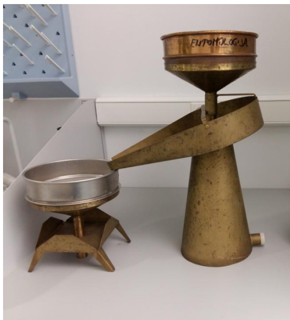
Slika 16. Fenwickov uređaj (Izvor: Anja Kolarić)
