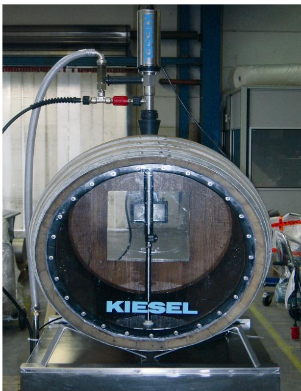
Slika 8: Perač drvenih bačava Njemačke tvrtke Kiesel
