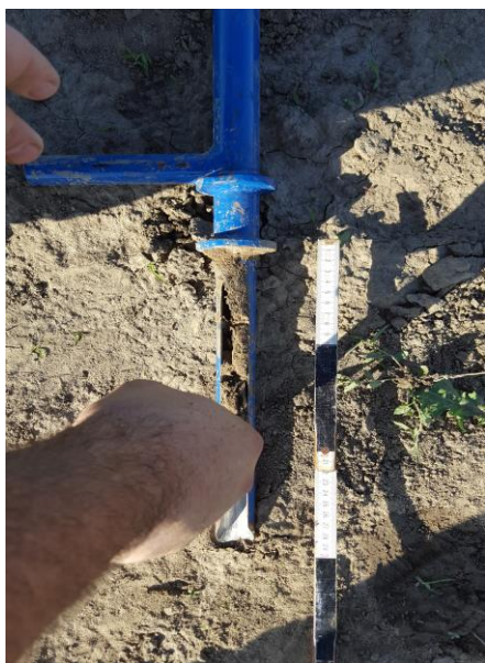
Slika 6. Uzorkovanje tla s određenih dubina
