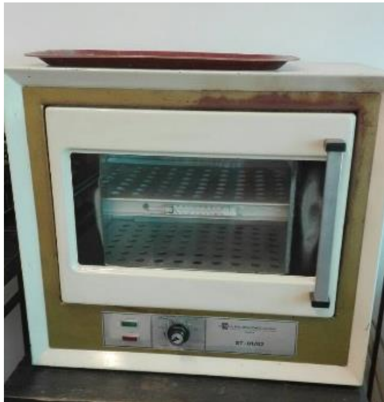
Slika 9. Sušenje uzoraka tla u sušioniku
