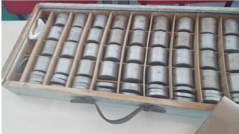
Slika 8. Metalne posudice za sušenje uzoraka tla
