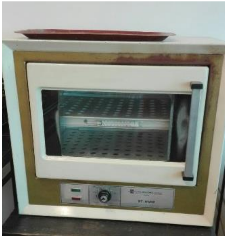
Slika 9. Sušenje uzoraka tla u sušioniku
