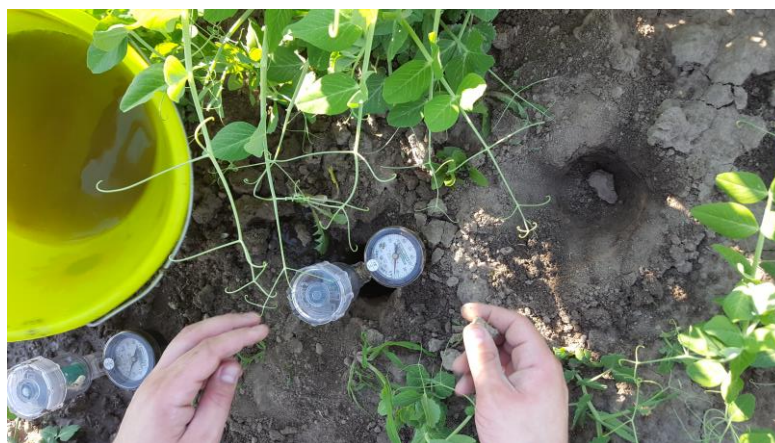
Slika 3. Tenziometri postavljeni u tlo
