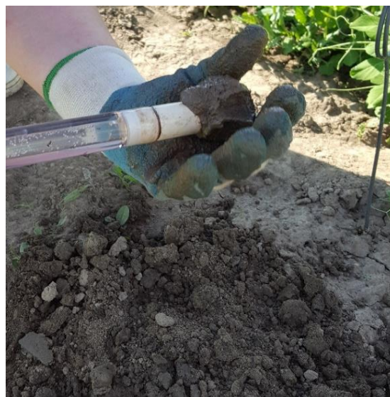
Slika 2. Oblaganje keramičke kapice vlažnim tlom
