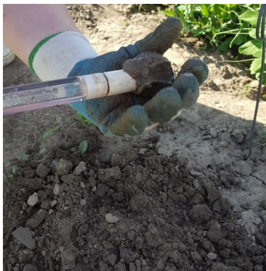
Slika 2. Oblaganje keramičke kapice vlažnim tlom
