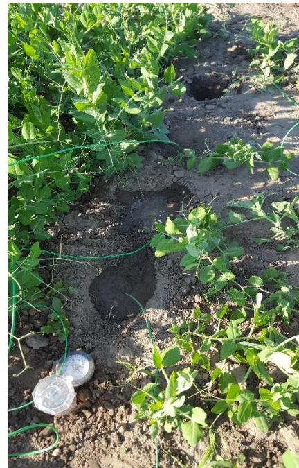
Slika 6. Tenziometar i Watermark uređaji postavljeni u tlo
