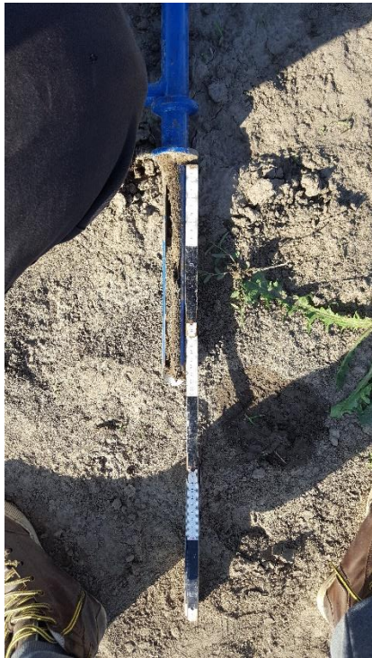
Slika 2. Određivanje dubine za uzrokovanje tla
