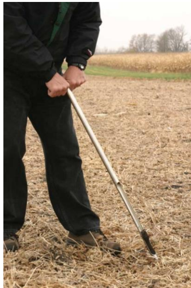
Slika 7. Uzorkovanje tla sondom
