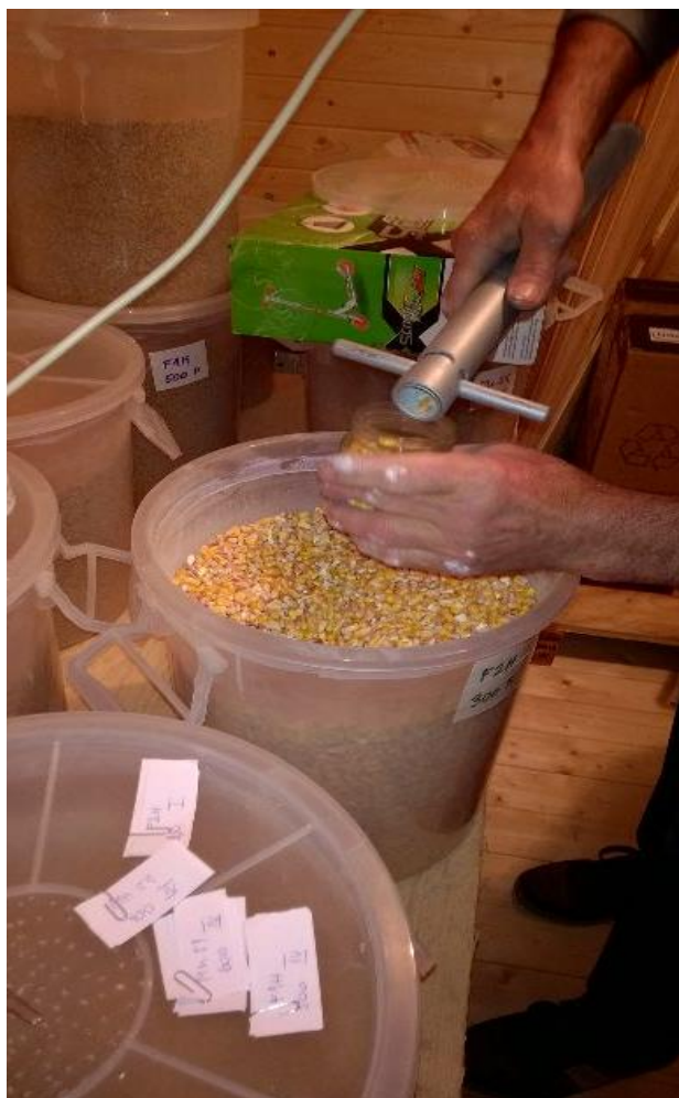
Slika 7. Izuzimanje poduzoraka 100 g zrna kukuruza pomoću sonde
