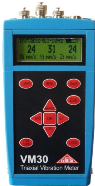
Slika 15. Uređaj za mjerenje vibracija MMF VM30 (URL11)
