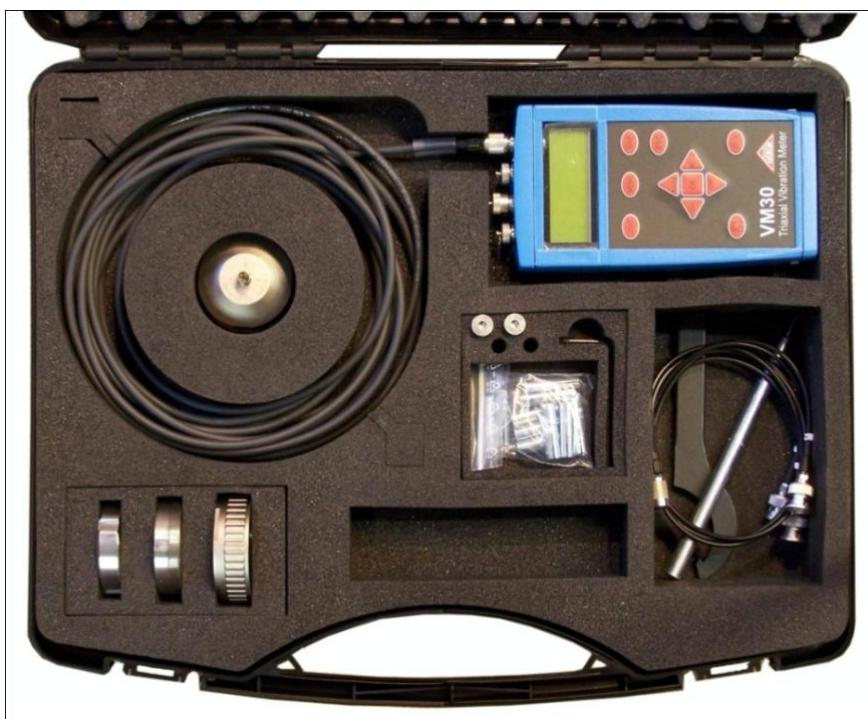
Slika 15. Oprema i uređaj za mjerenje vibracija. (URL)
