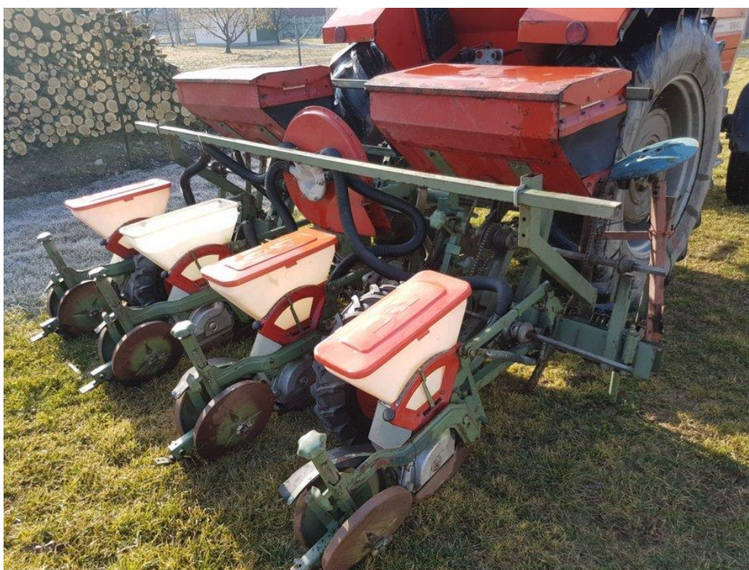
Slika 10. Četveroredna pneumatska sijačica marke OLT
