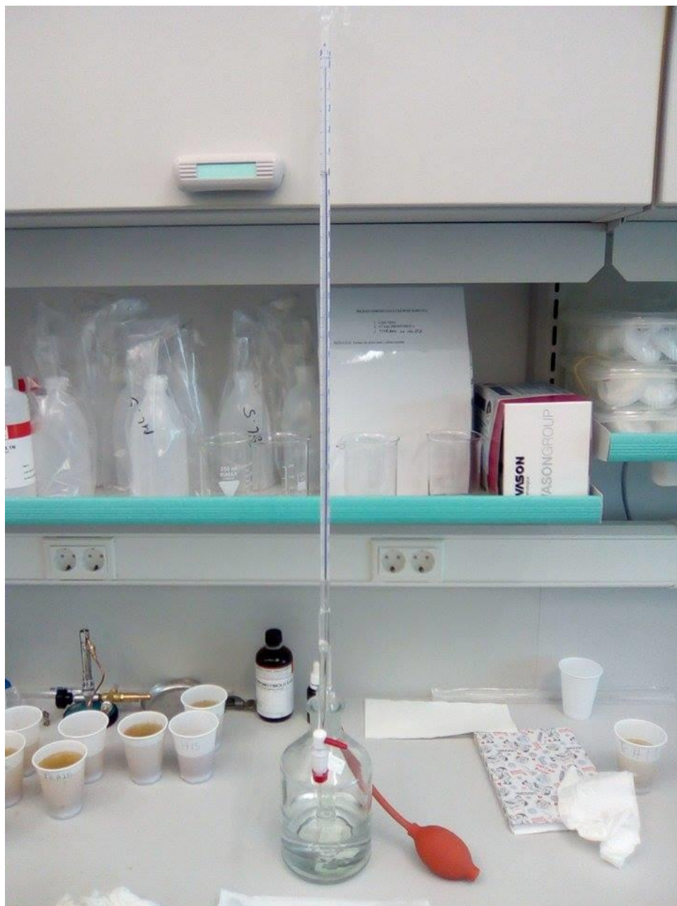
Slika 17. Bireta za određivanje ukupne kiselosti mošta (Autor, 2017.)
