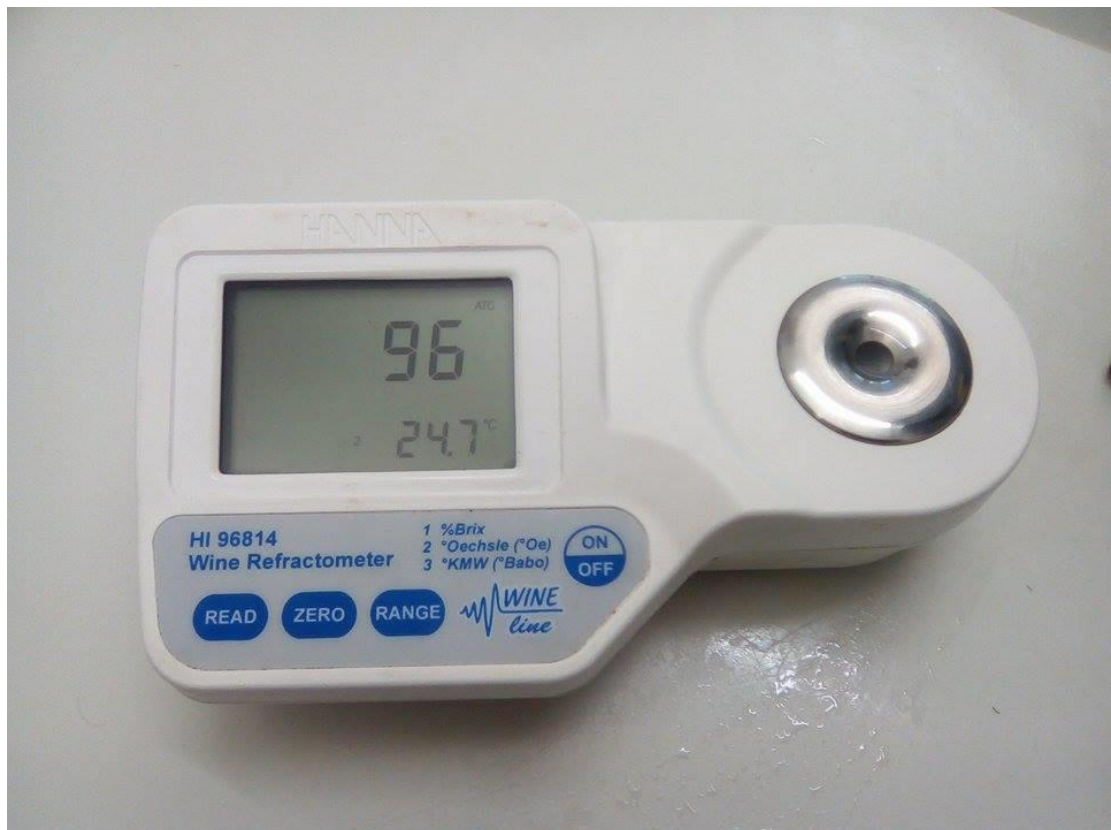
Slika 16. Digitalni refraktometar (Autor, 2017.)
