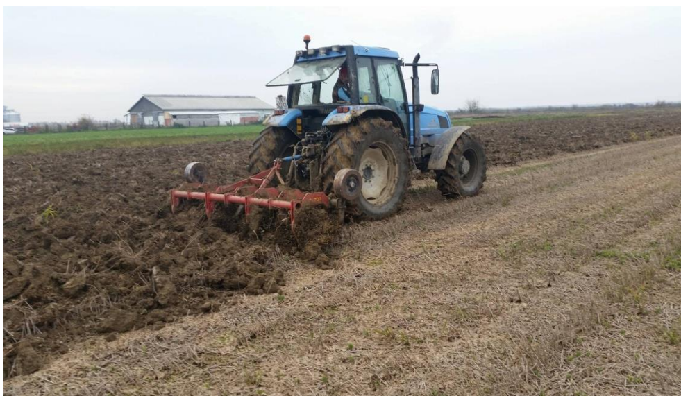
Slika 2. Duboka obrada tla podrivačem (foto: Ivan Goreta)
