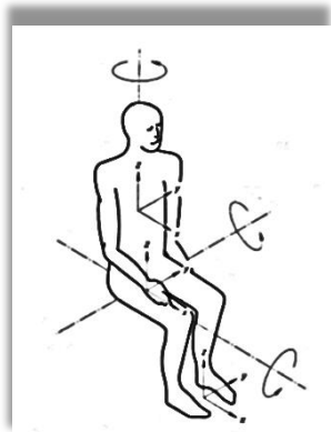
Slika 8. Pravci djelovanja vibracija
