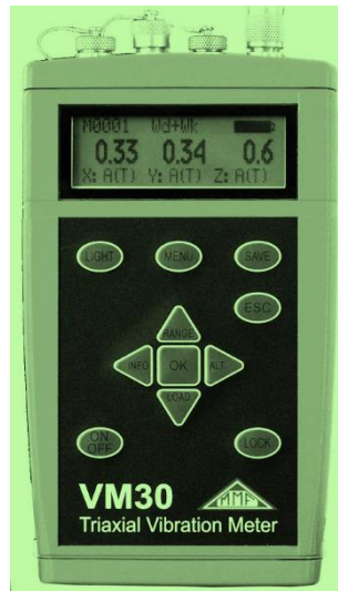
Slika 11. Uređaj za mjerenje vibracija MMF VM30-H (URL6)
