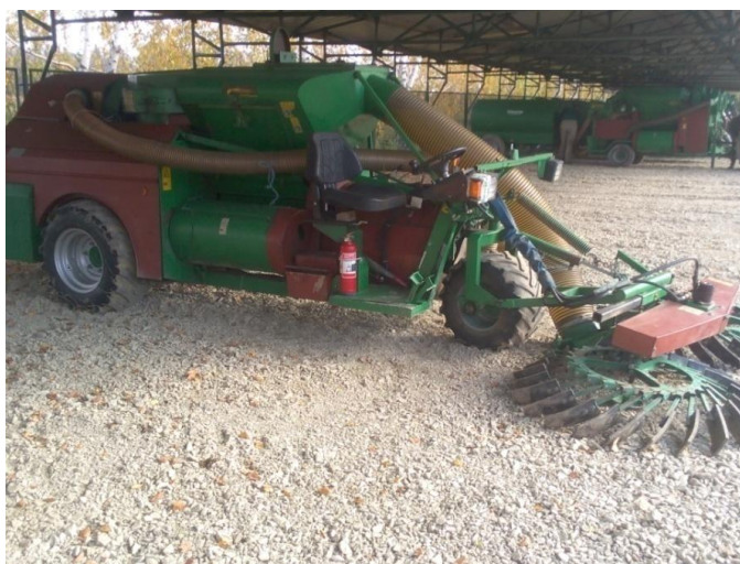
Slika 20. Samohodni stroj za sakupljanje lješnjaka „Facma“
