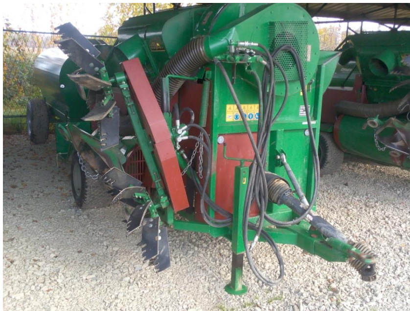
Slika 14. Vučeni stroj za sakupljanje lješnjaka „Facma“
