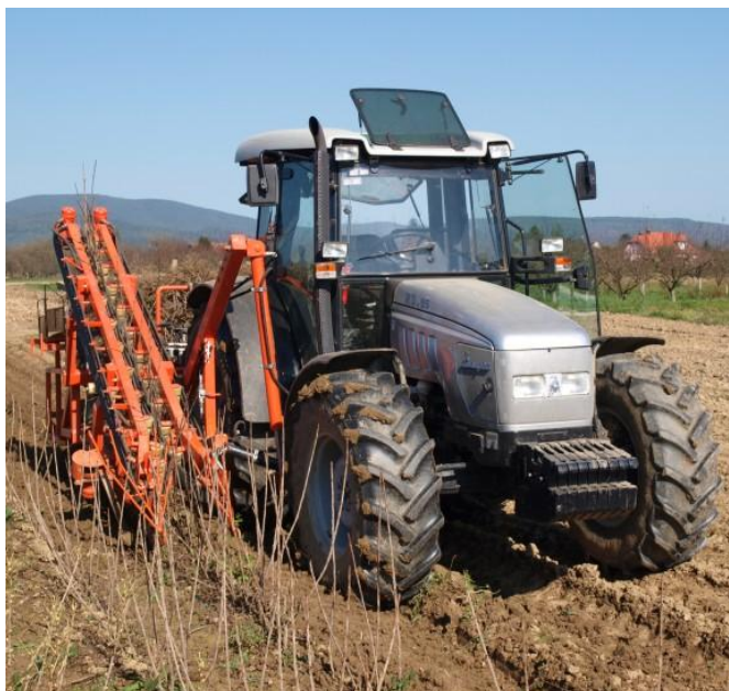
Slika 25. Uklještavajući kombajn za vađenje sadnica lijeske
