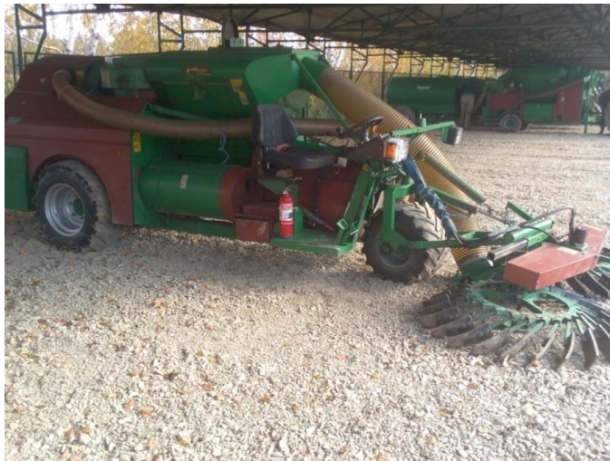
Slika 20. Samohodni stroj za sakupljanje lješnjaka „Facma“
