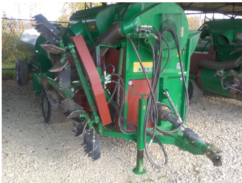
Slika 14. Vučeni stroj za sakupljanje lješnjaka „Facma“
