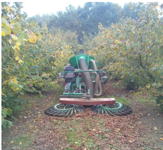
Slika 17. Samohodni stroj za skupljanje lješnjaka „Facma“
