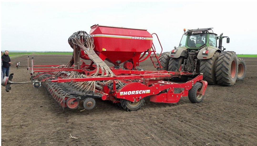
Slika 17. Sijačica Horsch Pronto (izvor: Kalac B., 2016.)
