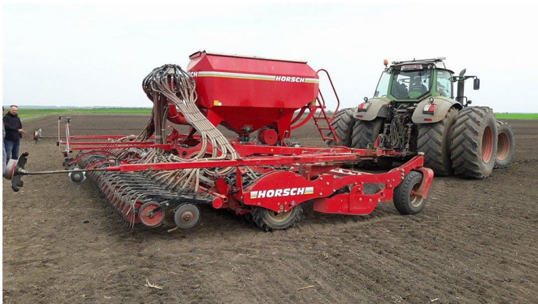
Slika 17. Sijačica Horsch Pronto (izvor: Kalac B., 2016.)
