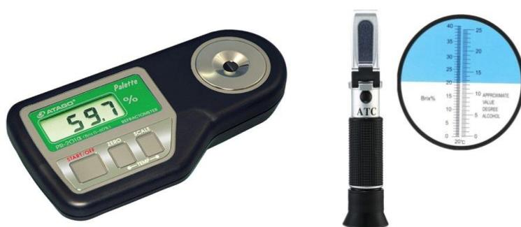
Slika 6. a) Digitalni refraktometar (izvor: [www.ru-ve.hr](http://www.ru-ve.hr)), b) ručni refraktometar (Pinterest)
