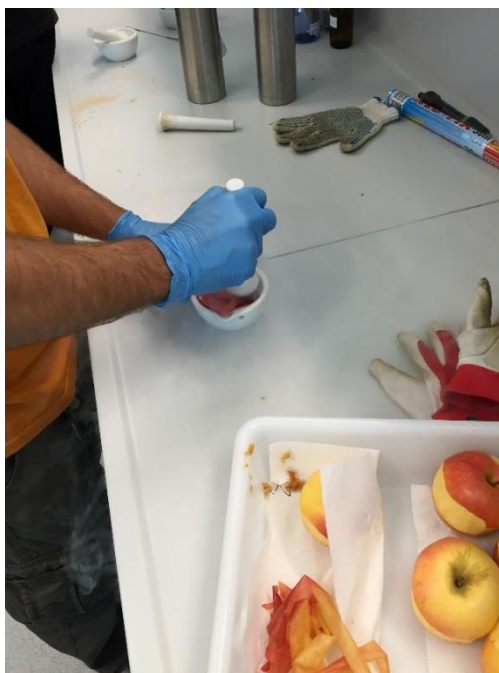
Slika 16. Maceriranje pokožice tekućim dušikom (autor: Đurković, 2015.)
