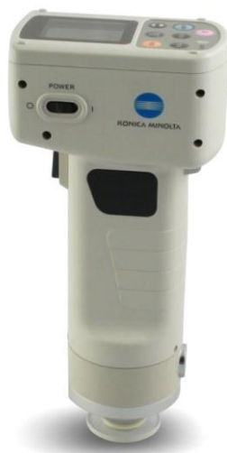
Slika 15. CR-400 chromametar (izvor: http://sensing.konicaminolta.asia/ )
