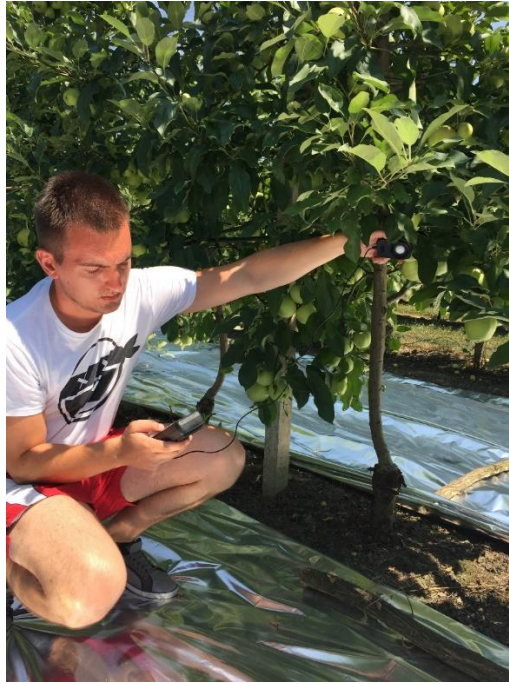
Slika 10. Mjerenje refleksije svjetlosti Lux metrom (autor: Đurković, 2015.)
