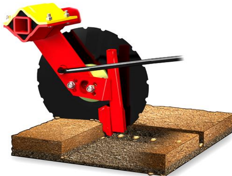
Slika 18. Shema rada sustava za ulaganje sjemena sijačice Rapid 400C
