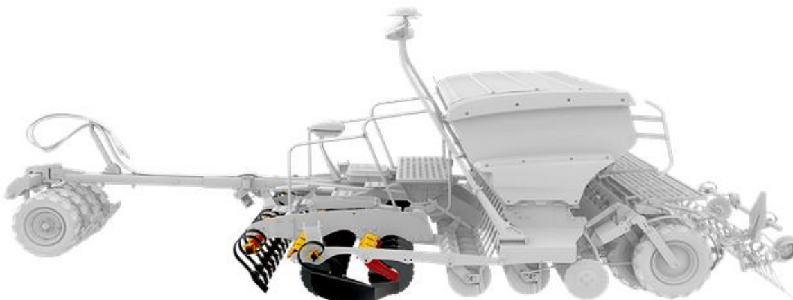
Slika 26. Druga zona rada sijačice Rapid 400C
