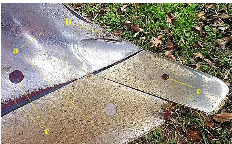
Slika 10. Tragovi trošenja alata za obradu tla (lemeš, crtalo i odgrnjača)
